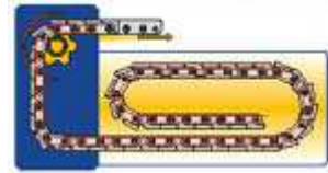
9 - Stockage horizontal. Talon haut avec magasin bas, carter avec magasin à 3 brins guidés
